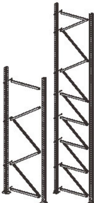
Spalle di altezza modulare con passo di mm 500
